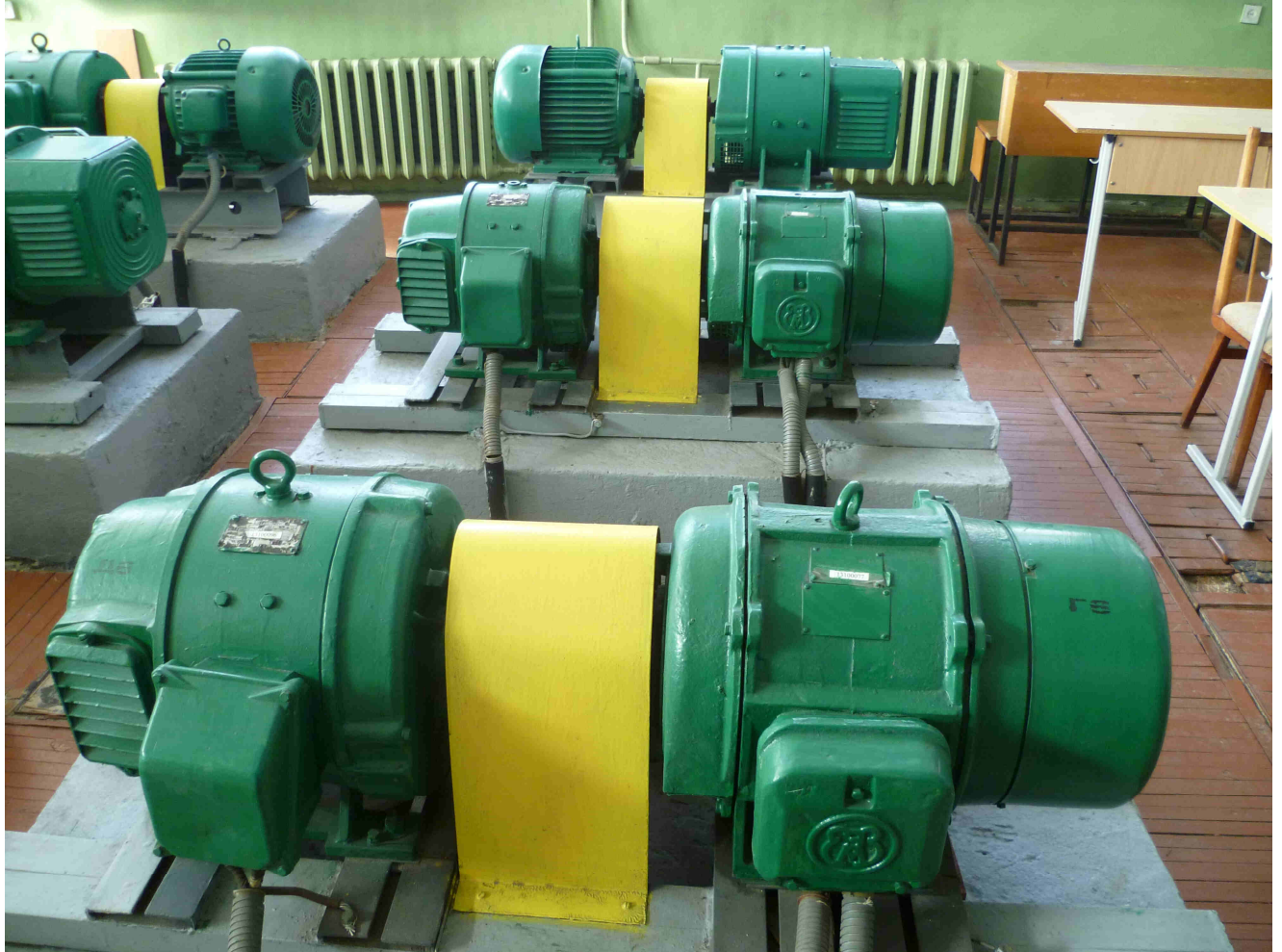
Рис.2. Зовнішній вигляд неявнополюсних синхронних генераторів Г5, Г6 з відповідними двигунами постійного струму (Д5, Д6)
